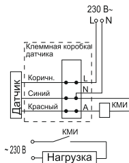
Рисунок 8 – Схема подключения датчиков с контактором КМИ
