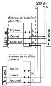
Рисунок 6 – Схема параллельного подключения датчиков движения
